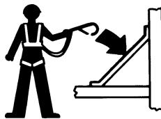
平台上的人员必须佩带安全带或使用安全设施，并应遵守适用的规章制度。将系索系在平台的锚上。
