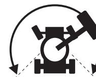
注意：使用驱动启用系统时，机器可按行驶和转向控制手柄移动的相反方向行驶。
